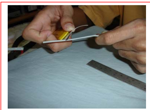
รูปที่ 5 การปอกสายไฟฟ้า
